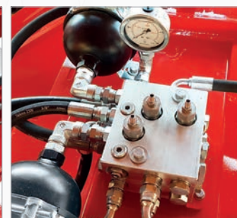
Blokada zaworów hydraulicznych
